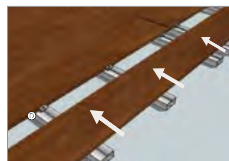
PT - Clip aparafusado à viga. ENG - Screw clip to the beam and slide the deck board. FR - Vissez le clip à le lambourde et faites glisser la lame de deck. DE - Klammer an den Balken verschraubt. ES - Clip atornillado a la viga.
