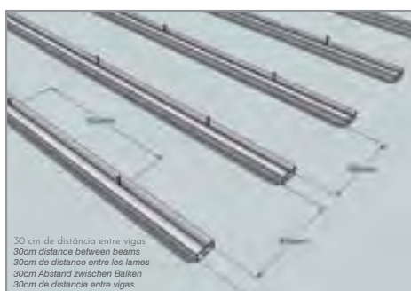
PT - Fixação das Vigas diretamente ao solo, a cada 50cm, e a 5cm das extremidades. ENG - Fix the beams directly to the soil, every 50cm and 5cm from the ends. FR - Les lambourdes sont fixées solidement sur au sol tous les 50cm. DE - Befestigung der Unterstruktur direkt auf den Boden, 50cm entfernt voneinander und 5cm von den Rand. ES - Fijación de las vigas directamente al suelo, 50cm de distancia entre si y 5 cm de los extremos.
