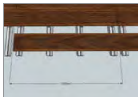
PT - Aplicação do Deck sempre desfasada a 50%. ENG - Always Lagged deck fixing - 50% piece. FR - Application de la lame toujours décalé 50%. DE - Quer verlegen 50%. ES - Aplicación transversal 50% de la pieza.
