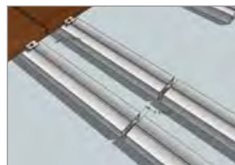
PT - Distância entre vigas e entre régua de deck 6/8mm. ENG - Distance between beams and between deck boards 6/8mm. FR - Distance entre les lambourde et entre les lames de deck 6/8mm. DE - Abstand zwischen Tragebalken und Deck-Regeln 6/8mm. ES - Distancia entre las vigas y las reglas de deck 6/8mm.
